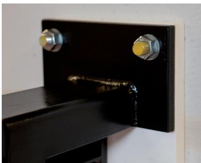
Les couches de **COMPACFOAM** servent typiquement sous les consoles dans la construction métallique ou de support à des composants béton. La propriété ductile du matériau égalise une grande partie des inégalités du support.
