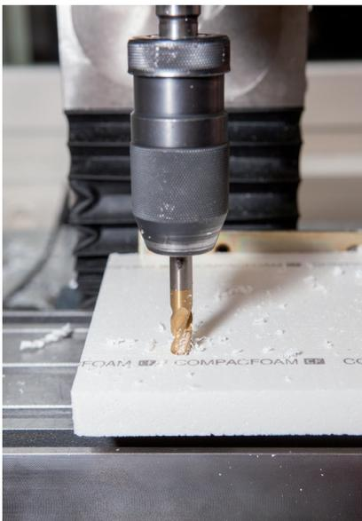
Nos plaques, tiges, barres profilées, cubes et blocs ont un poids relativement réduit. Cela facilite leur manipulation. De plus, ils sont faciles à visser, percer, calibrer et fraiser avec des machines usuelles pour le travail du bois.
