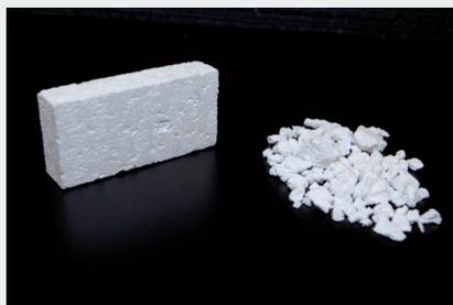
Avec l'aide d'un nouveau procédé, la technologie de particules, nous pouvons recycler à 100 % les chutes de **COMPACFOAM**. **CF eco**, le résultat de ce procédé, offre les mêmes propriétés avantageuses que **COMPACFOAM** : une résistance élevée pour une excellente isolation.
