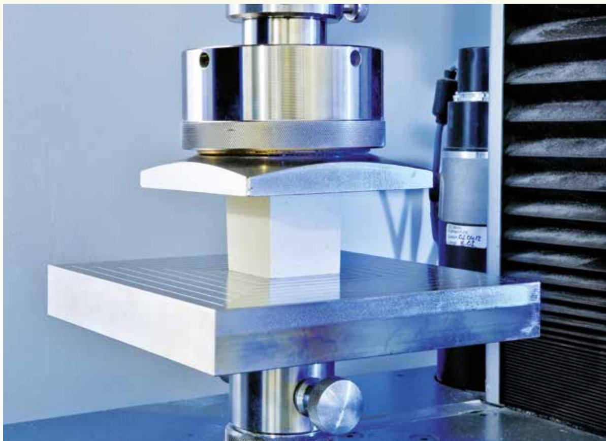
purenit® est extrêmement résistant à la compression, comme le prouvent ses caractéristiques techniques. Élément de construction ou matériau central dans des constructions sandwich, purenit® répond parfaitement à toutes les attentes.
