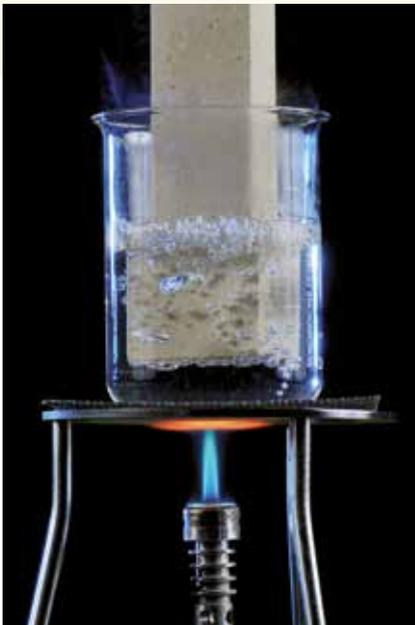
Nombreux sont les matériaux mis à rude épreuve par l'humidité. purenit® ne se déforme pas, même dans l'eau bouillante.
